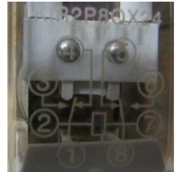
**Figure 37: Relay Schematic**
