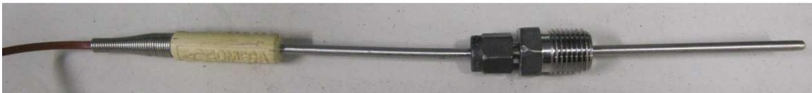
**Figure 38 : Thermocouple Type K**
