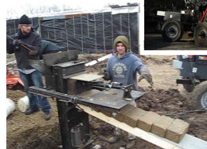
*Prensa de Ladrillos de Tierra Comprimida funcionando*
